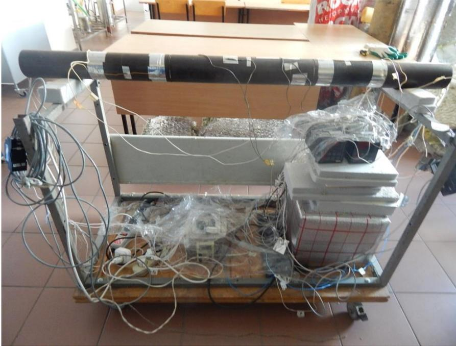
Измерения теплопроводности изоляционных материалов проводятся в соответствии с ГОСТ 32025-2012 (EN ISO 8497:1996), ГОСТ 7076-99.
