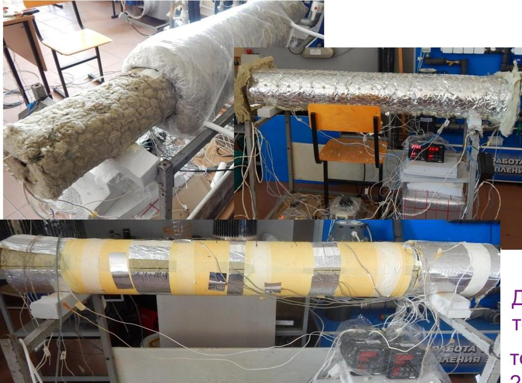
Нагрев испытательной трубы осуществлялся электроконтактным методом. Общая длина испытательной трубы 1440 мм, наружный диаметр 89 мм.
