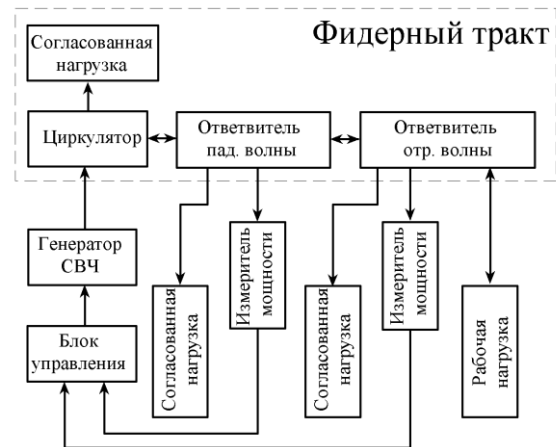
Схема контроля КСВ
