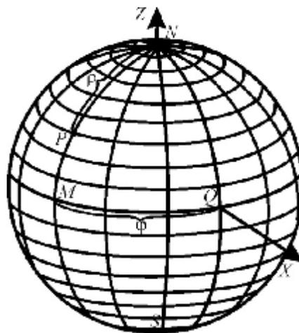
*Рис. 1.3.* Сферическая система координат:  $P$  - произвольная точка на поверхности сферы с угловыми координатами  $\varphi$  и  $\rho$ ;  $Q$  - точка на экваторе с  $\varphi=0$
