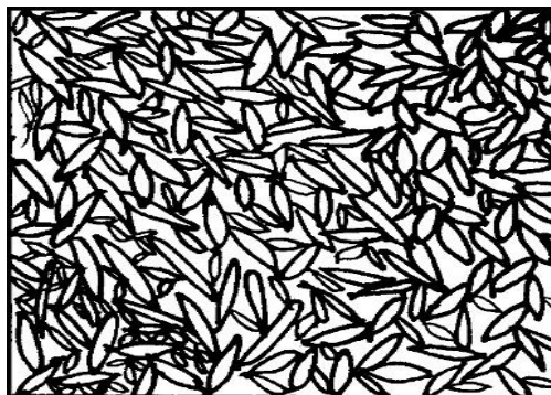
Рис. 4.4. Схема микроструктуры доэвтектоидной стали 45 после полной закалки в воде. Мартенсит
