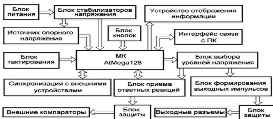
Рис.1 Структурная схема программно-аппаратного комплекса для диагностики неисправностей цифровых систем
