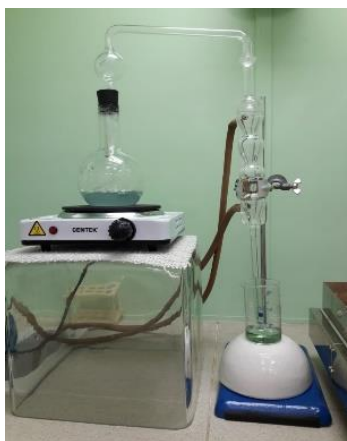
Рис. 1. Установка и процесс определения азота в помёте
