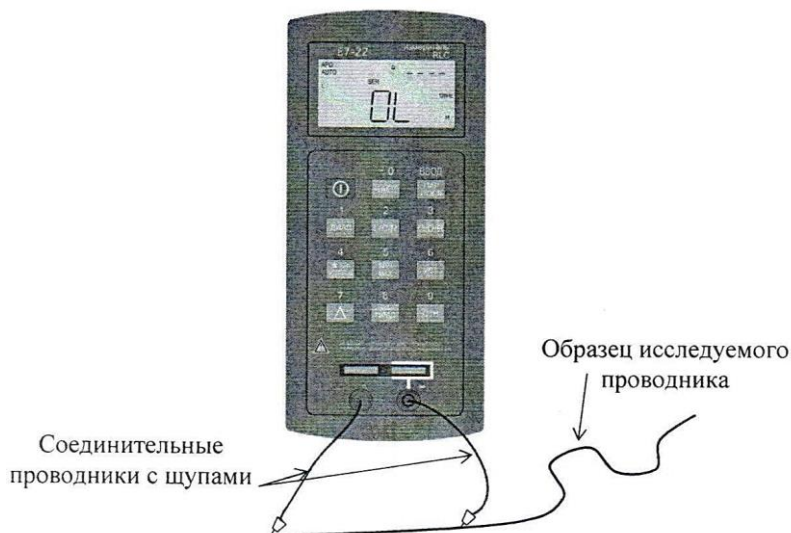
Рис. 1.9. Измерение сопротивления проводника RLC -метром
