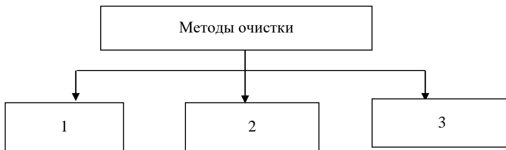
Рисунок 6.1 – Методы очистки отходящих газов: 1 – физические; 2 – химические; 3 – биохимические
