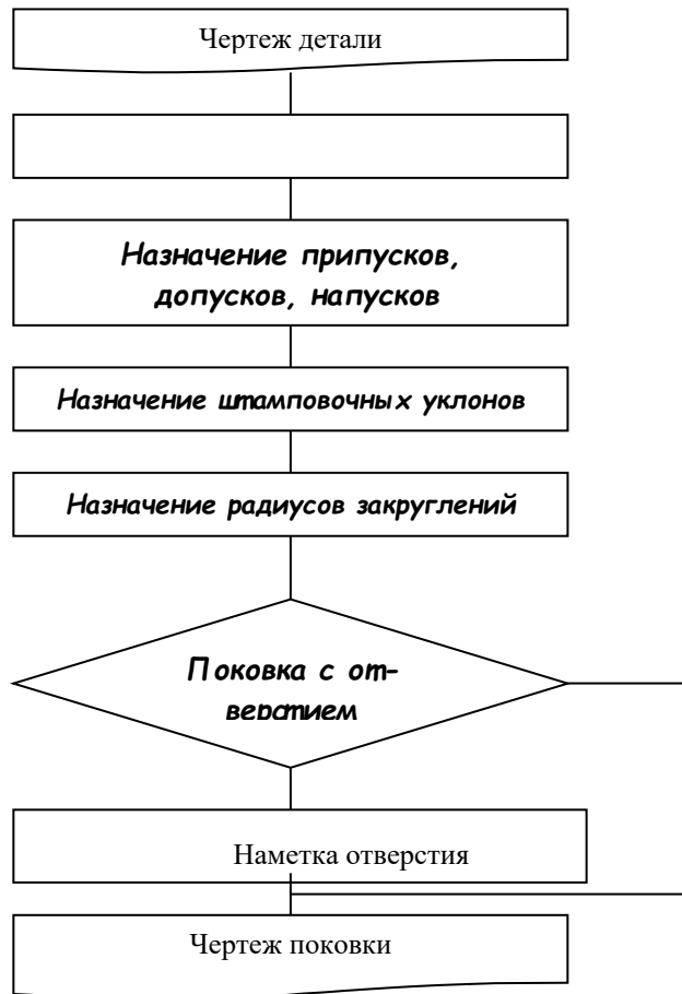
Рис. 2.1. Схема алгоритма разработки чертежа поковки.
