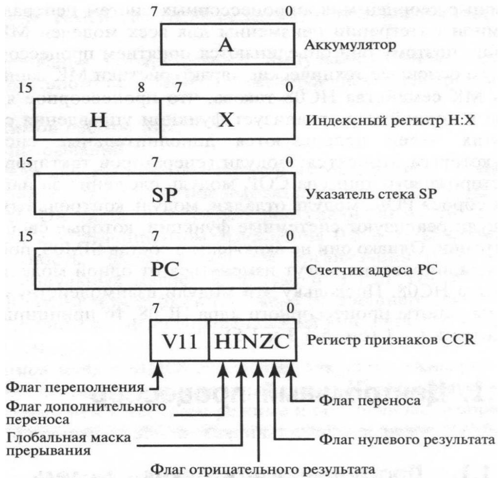
Рисунок 1.5 Программно-логическая модель центрального процессора HC08
