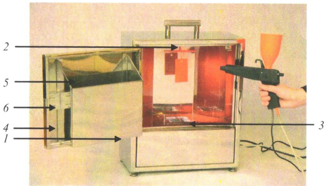
Рис. 2.1. Переносная камера напыления для нанесения порошковых полимерных покрытий
