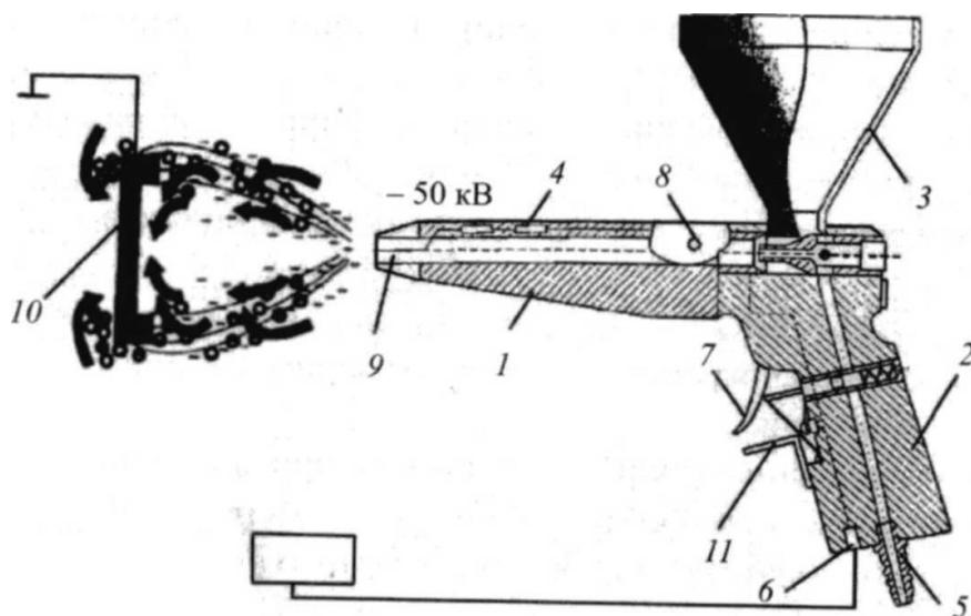
Рис. 2.4. Пистолет-распылитель: 1 – ствол; 2 – рукоятка; 3 – воронка; 4 – источник высокого напряжения; 5 – штуцер для подачи сжатого воздуха; 6 – гнездо для подключения к электро-сети курок; 8 – индикатор напряжения; 9 – бронирующий электрод; 10 – заземленное изделие; 11 – скоба заземления
