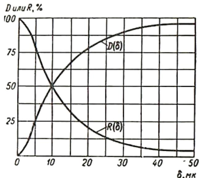
Рис. 1.1. Кривые распределения измельченного материала
