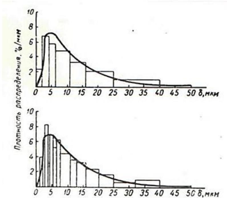
Рис. 1.2. Гистограммы одного и того же порошка при различных диапазонах фракций и кривая плотности распределения
