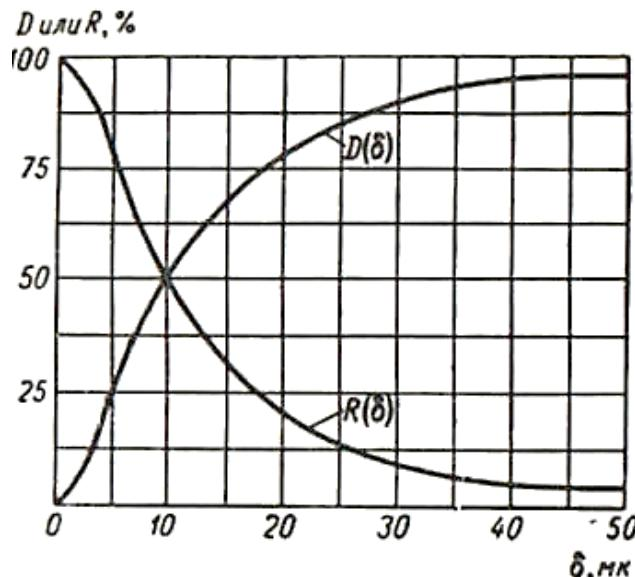
Рис. 1.1. Кривые распределения измельченного материала
