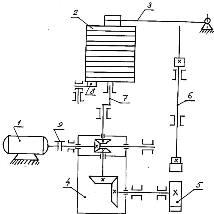
Рис. 1.5. Кинематическая схема установки для ситового анализа измельченных материалов:
