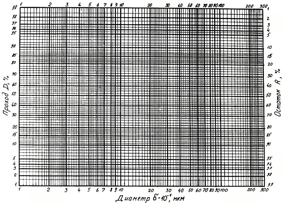
Рис. 1.3. Логарифмически вероятностная координатная сетка
