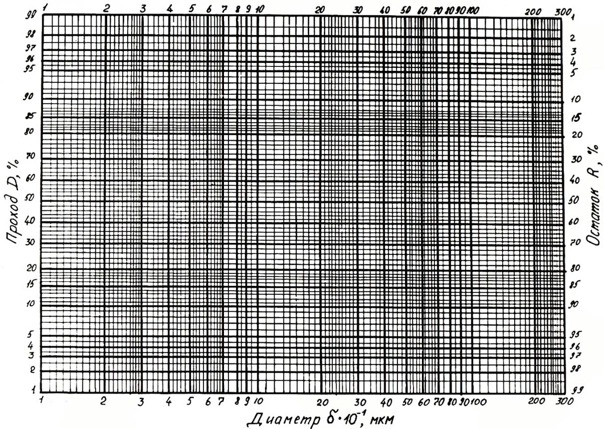
Рис. 1.3. Логарифмически вероятностная координатная сетка
