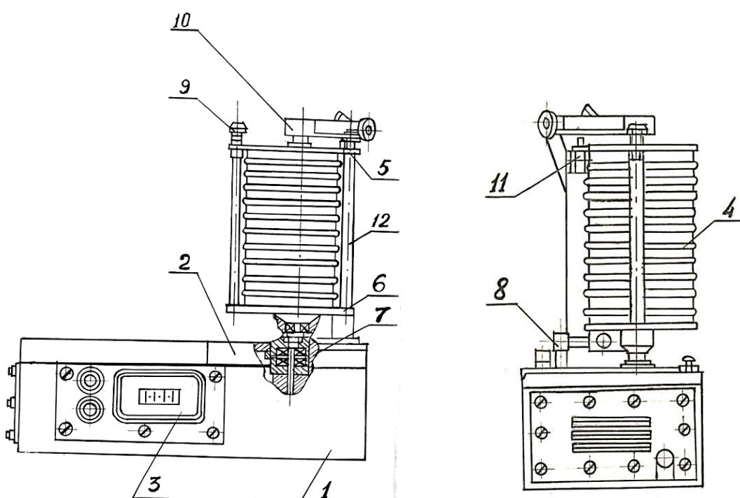
Рис. 1.4. Установка для ситового анализа измельченных материалов:
