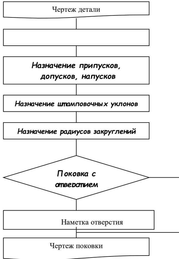
Рис. 2.1. Схема алгоритма разработки чертежа поковки.
