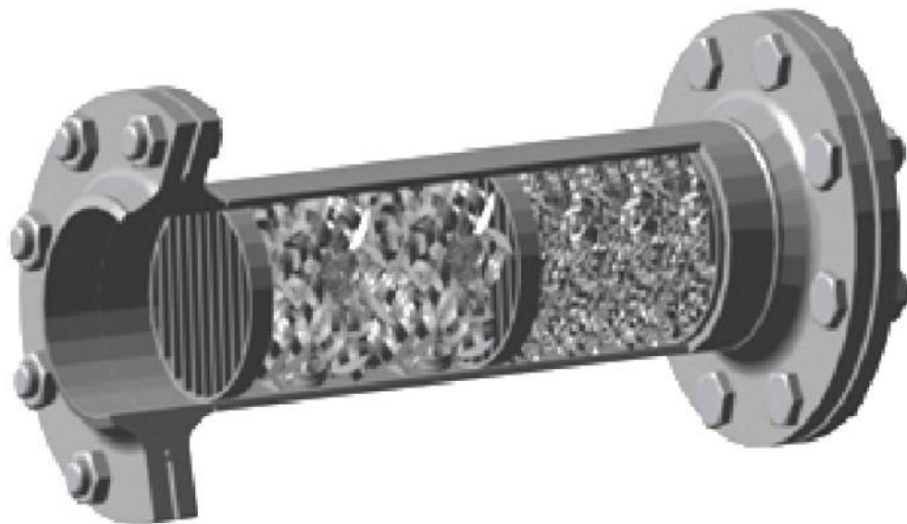
Рис. 4 – Вид канала с объемными интенсификаторами
