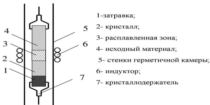
Рис. 20. Схема выращивания кристалла методом бестигельной зонной плавки [1]
