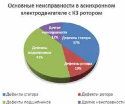
Рис. 2. Статистика повреждений асинхронного электродвигателя с короткозамкнутым ротором
