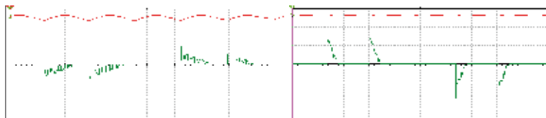
Рис. 2. Осциллограммы входного тока и постоянного напряжения ПЧ
