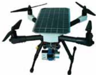
Рис. 1. Квадрокоптер на солнечной батарее
