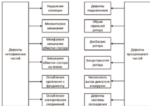
Рис. 1. Основные повреждения агрегатов с электрическим приводом
