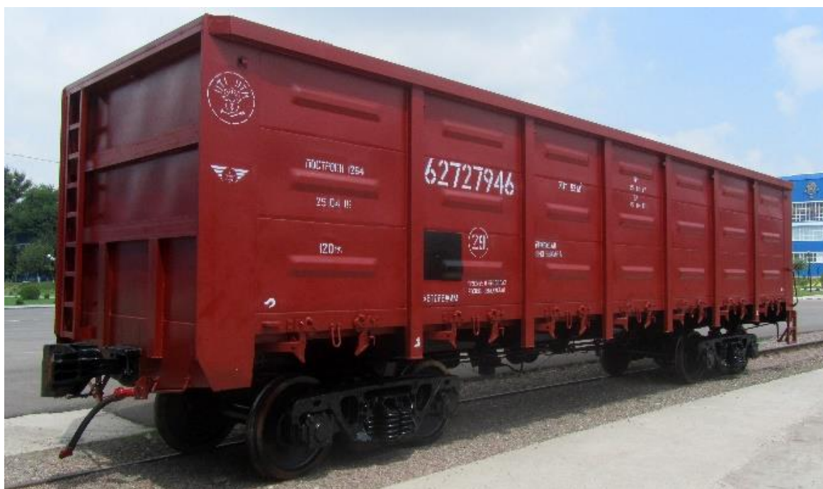
Общий вид кузова полувагона модели 12-9922 разработки и производства ДП «Литейно-механический завод»
