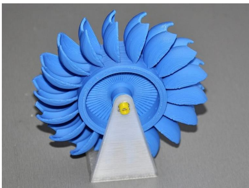
Рис. 2. Пример распечатанной и собранной модели турбины Пелтона
