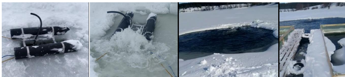
Рис. 2. Работа аэратора, установленного на пруде с. Абди (слева на право) в 1-й, во 2-й и на 3-й день работы
