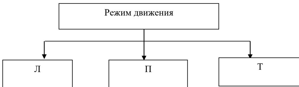
Рисунок 3.1 – Виды движения: Л – ламинарный; П – переходный; Т – турбулентный
