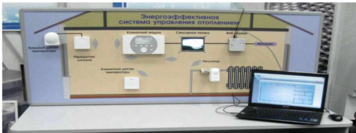
Рисунок 3.10. Демонстрационный учебно-экспериментальный стенд с использованием реального контура отопления помещения
