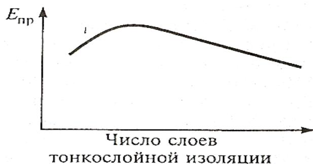
Рис. 10.3. Зависимость  $E_{\text{пр}}$  тонкослойной изоляции от числа слоев
