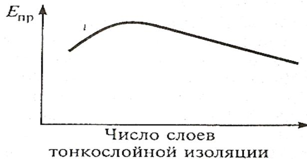
Рис. 10.3. Зависимость  $E_{пр}$  тонкослойной изоляции от числа слоев
