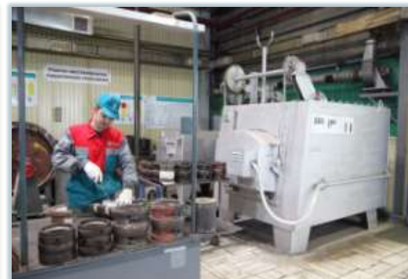
Восстановление подшипников скольжения крупных электрических машин
