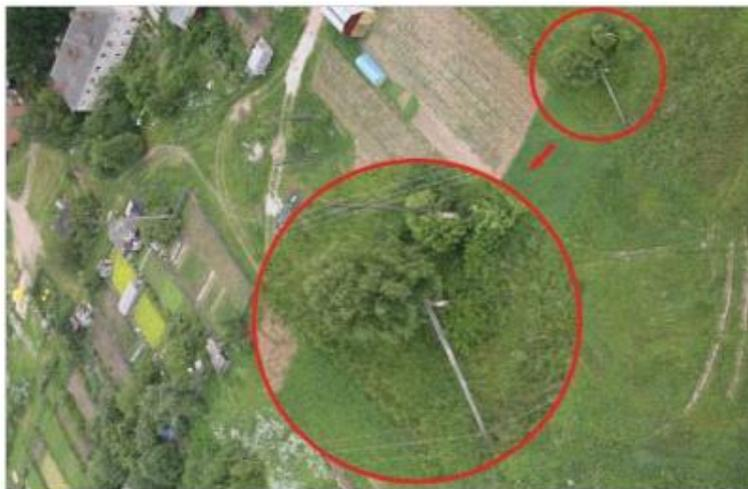
Рис. 2. Упавшая опора, зафиксированная Птеро-G0
