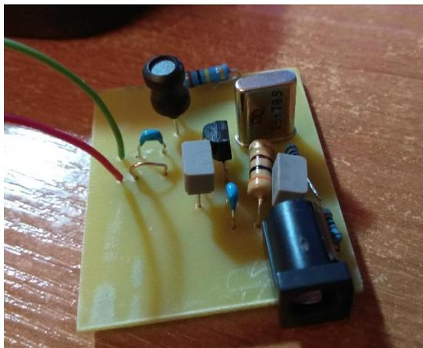
Рис. 3. Кварцевый генератор на 6,5 МГц после сборки
