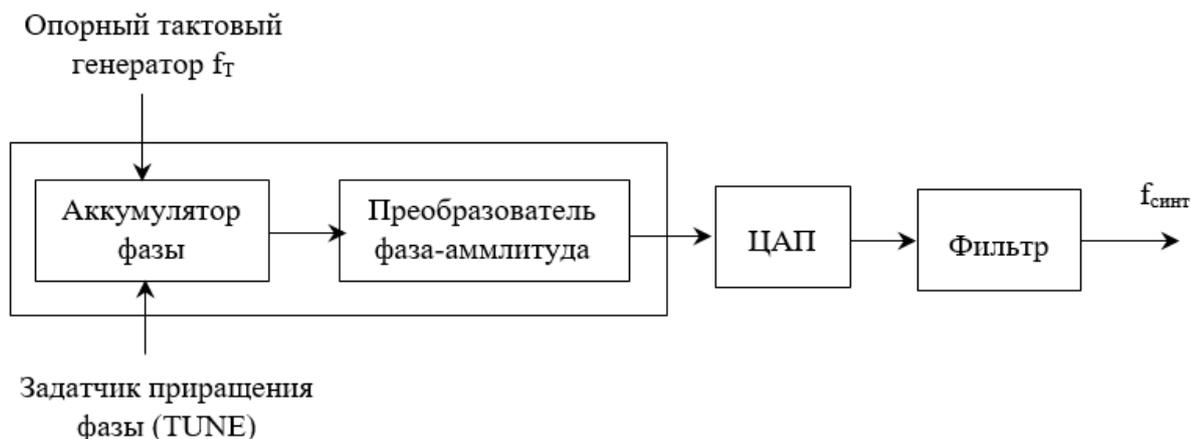
Структурная схема генератора на основе ПЦС
