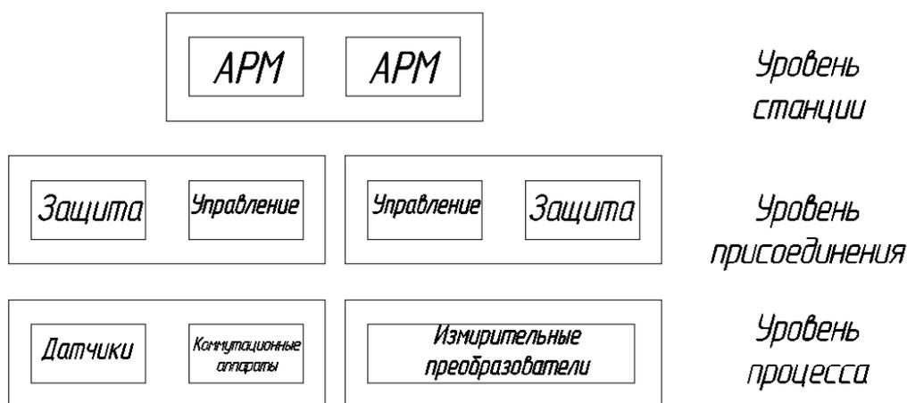
Архитектура системы автоматизации виртуальной ММПС
