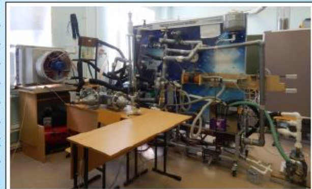
Экспериментальная установка для исследования пульсационных методов повышения эффективности теплообменного оборудования
