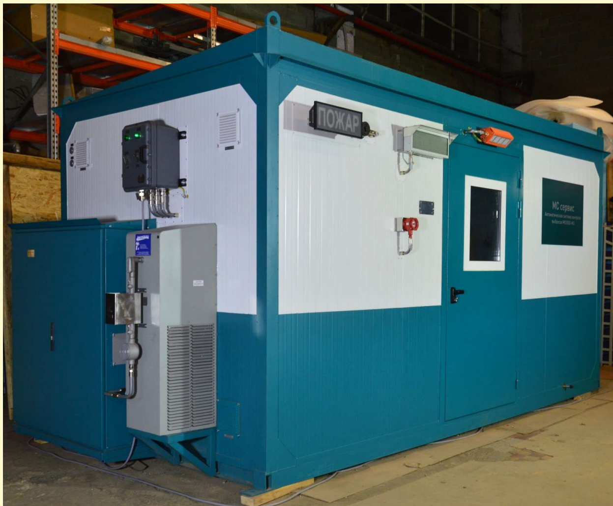
Автоматическая система контроля выбросов в атмосферу MS3550-M3 https://youtu.be/Bku1STDN4pA
