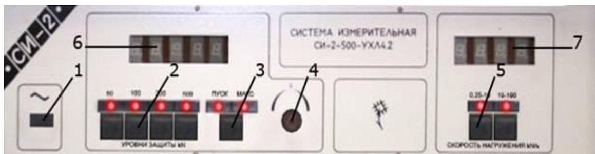
Рис. 7.7. Панель силоизмерителя СИ-2: 1–3 и 5 – соответственно кнопки включения прибора, уровня защиты напряжения, режимов отображения напряжения и уровней защиты скорости нагружения; 4 – ручка ручной настройки СИ-2; 6, 7 – числовое табло
