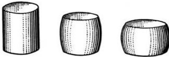
Рис. 7.1. Деформация стального образца при сжатии
