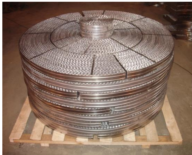
Рис. 1 Вид регулярной насадки: 1 – гофры смежных листов; 2 – центральный пакет; 3 – остальные пакеты
