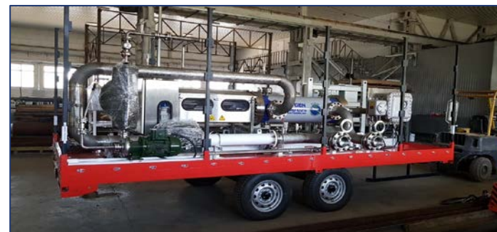
Мобильная поверочная установка для поверки коммерческих узлов учета нефтепродуктов для АО «ННК-ХАБАРОВСКИЙ НПЗ»
