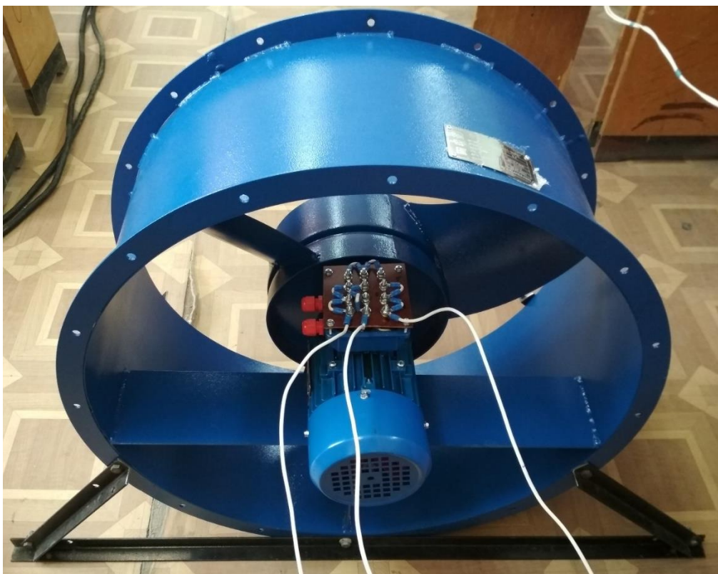
Рисунок 5.1 – Вентилятор ВО 06-300-6,3 с асинхронным двигателем с совмещённой обмоткой
