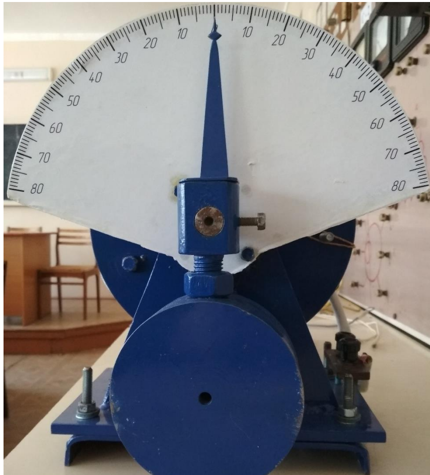
Рисунок 4.9 – Внешний вид нагрузочного устройства
