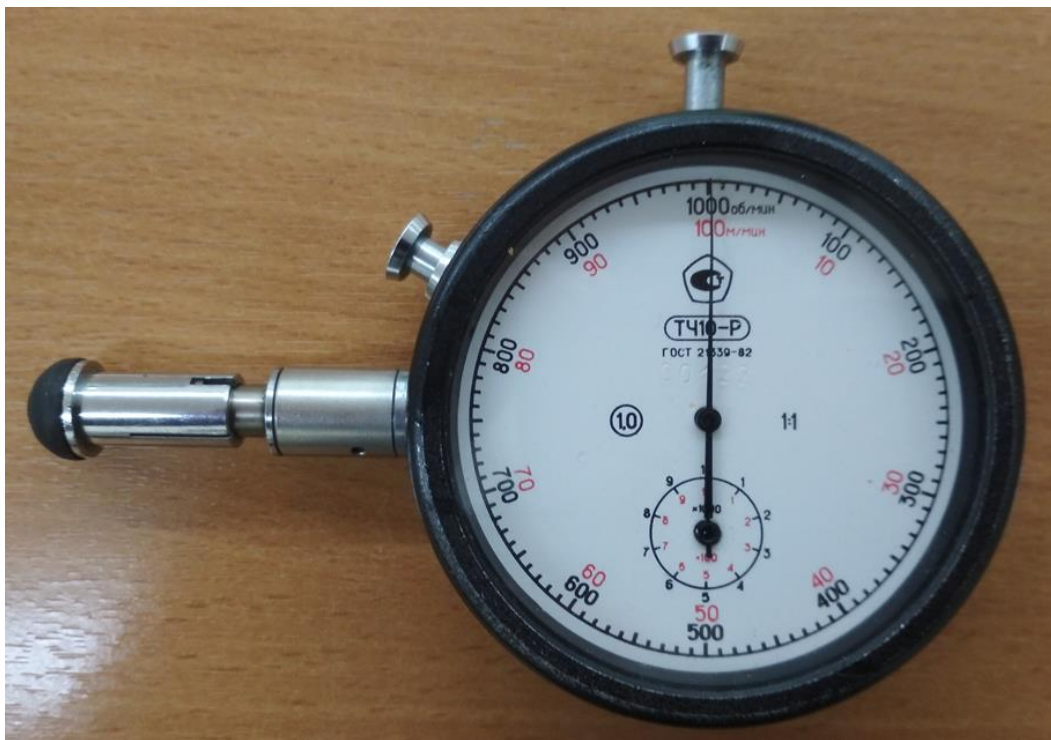
Рисунок 4.10 – Внешний вид тахометра ТЧ 10-Р
