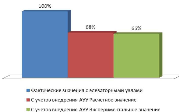
Рисунок 3.7. Относительные значения расхода сетевой воды и тепловой нагрузки на отопление для рассмотренных вариантов расчета.
