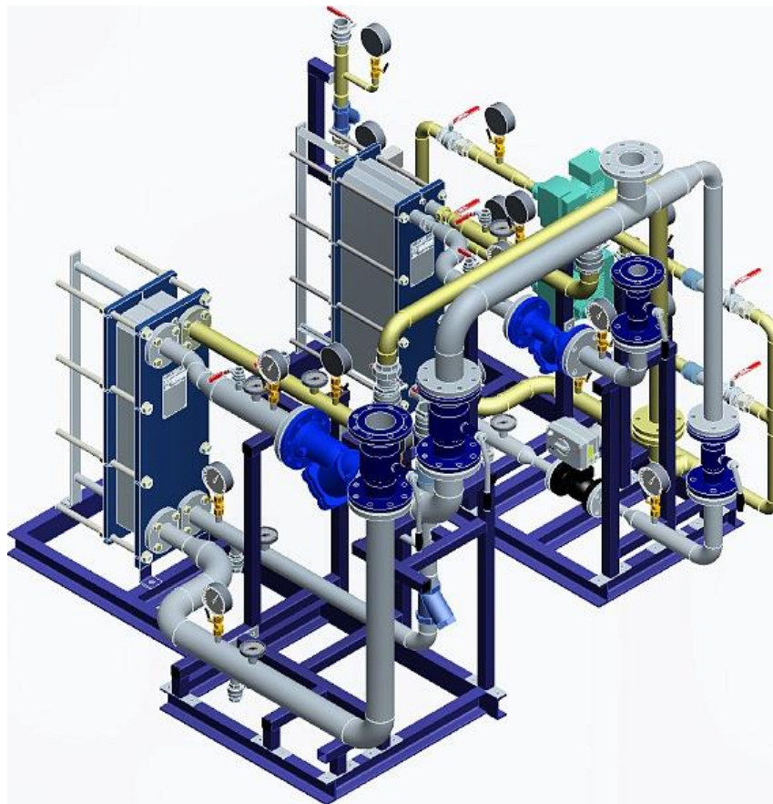
Рисунок 1.6. Современный модульный индивидуальный тепловой пункт в сборе
