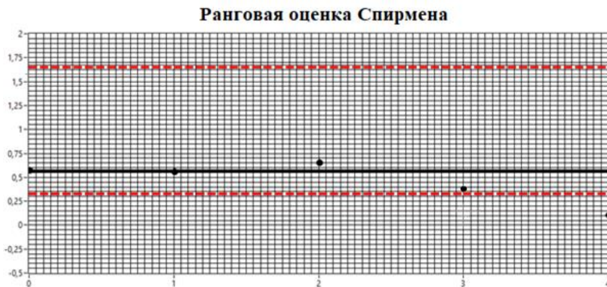
Рисунок 4.21. Оценка технического состояния обмоток и магнитопровода силового трансформатора ТСЗ 16 кВА по целевой функции «ранговая оценка Спирмена»
