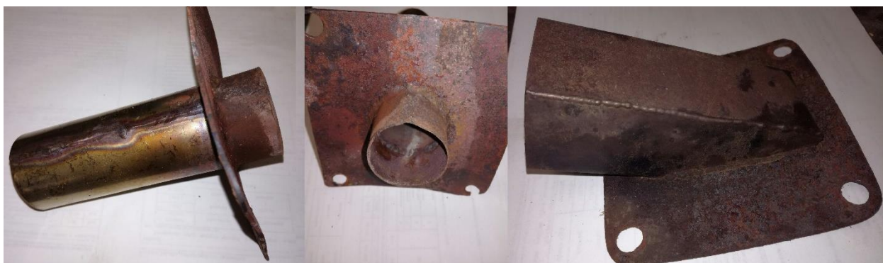
Рисунок 3.4 – Внешний вид сопел: радиальное, хордальное, тангенциальное (слева направо) [82]
