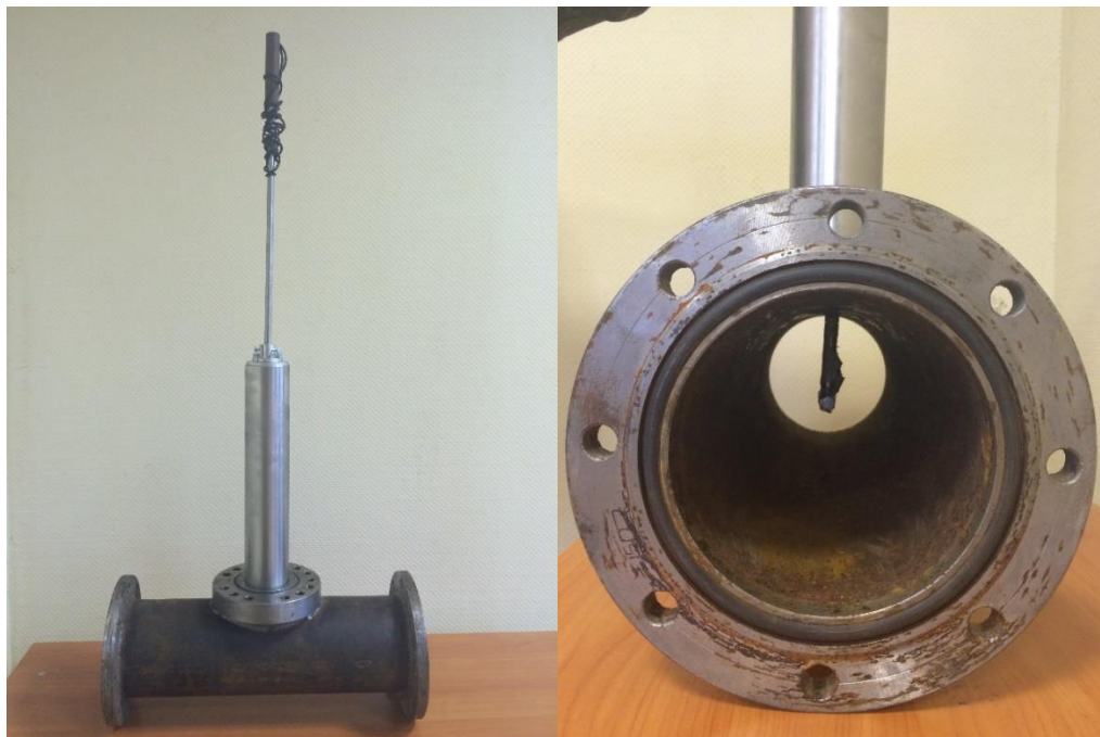
Рисунок 3.7 – Установка термоанемометра на калибровочной трубе при калибровке прибора ИРВИС-ТА5.2.
