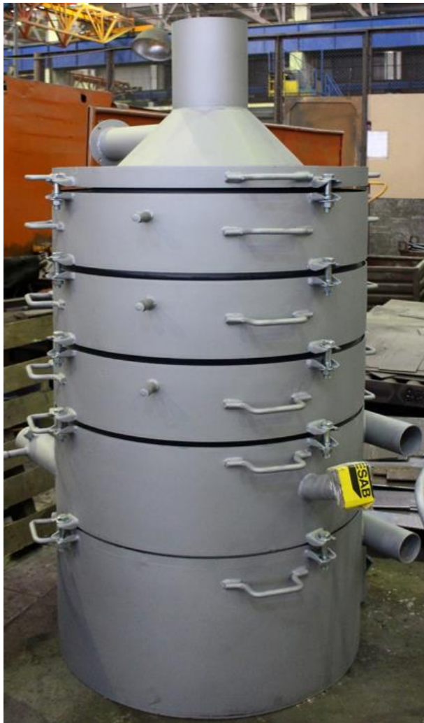
Рисунок 3.13 – Общий вид слоевой топки с вихревым движением газовой смеси
