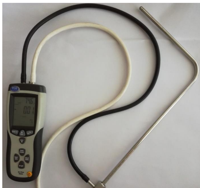
Рисунок 3.5 – Многофункциональный прибор PCE-PFM 2 в комплекте с трубкой Пито.
