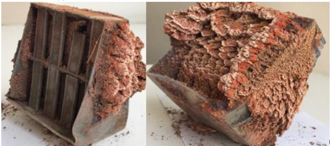
Рисунок 8 – Прямоугольный сепаратор после его применения в качестве предварительной ступени очистки на предприятии ООО «Каматек»
