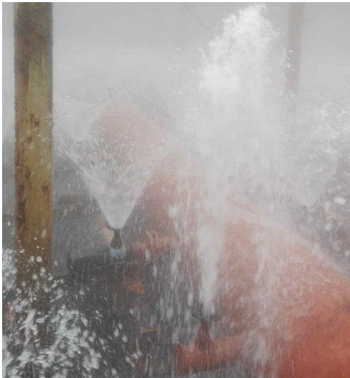
Рисунок А.4 – Поломленные и засоренные сопла
