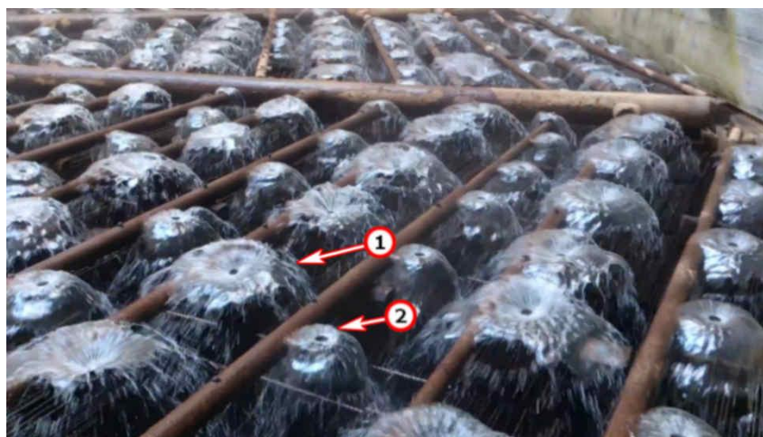
Рисунок 1.14 – Орошение воды при образовании отложений в трубах ВРС
