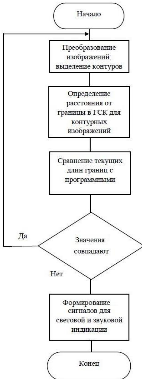
Рис. 2. Алгоритм функционирования бортового вычислителя
