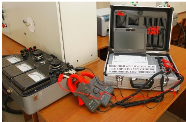
Рис. 2. Внешний вид прибора контроля энергетических характеристик системы «ПЧ – АД»
