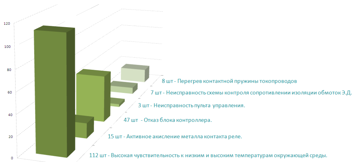
Рис. 1. Информация о количествах и причинах отказов ЭКТМ в период эксплуатации с 2007–2016 г.
