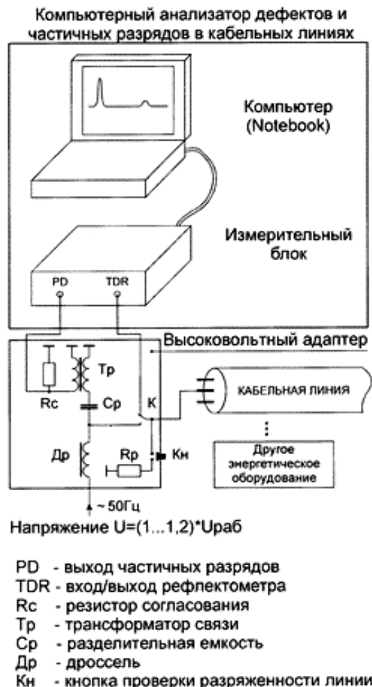
Рис. 2. Структурная схема измерений в кабельных линиях
