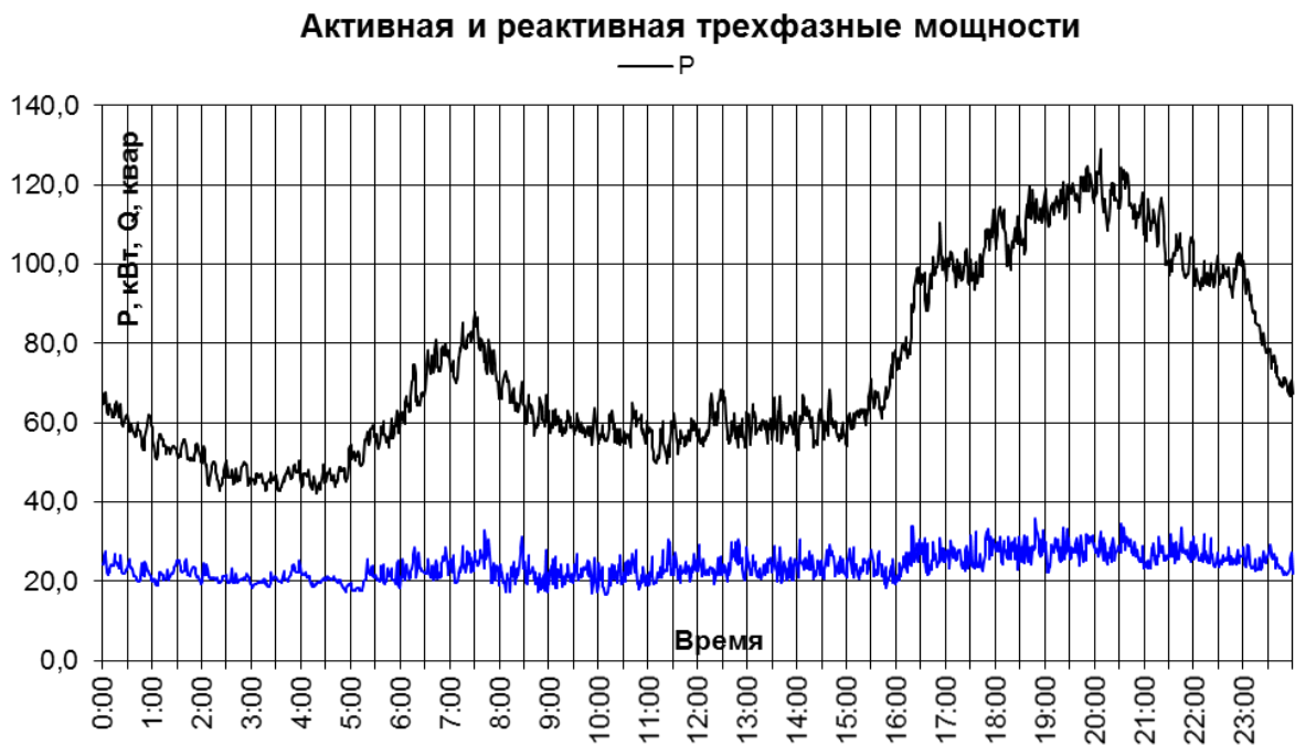
Рис. 2. График суточного потребления активной и реактивной мощности на вводе многоквартирного жилого дома
