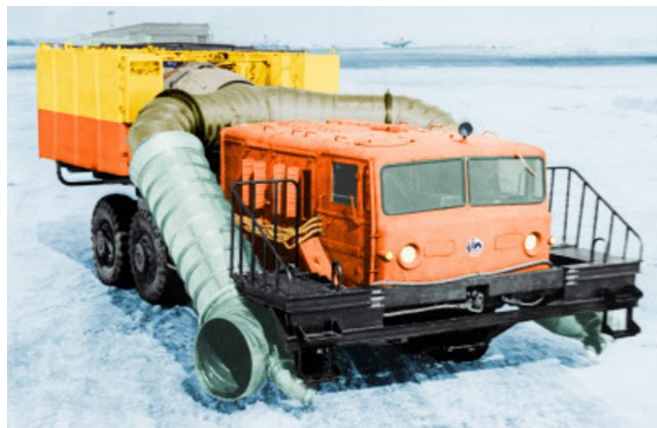
Рис. 12. Аэродромная газоструйная установка
