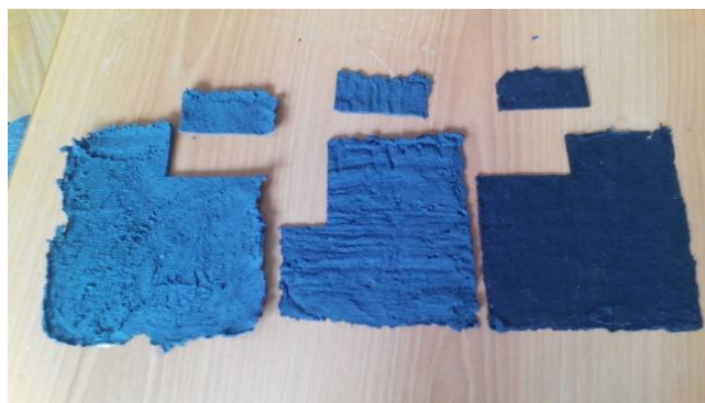
Рис. 1. Образцы дисперсных систем из графита и силикона
