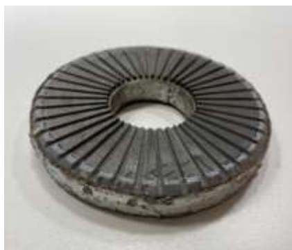
Рисунок 2 – Ротор двигателя без короткозамкнутой обмотки
