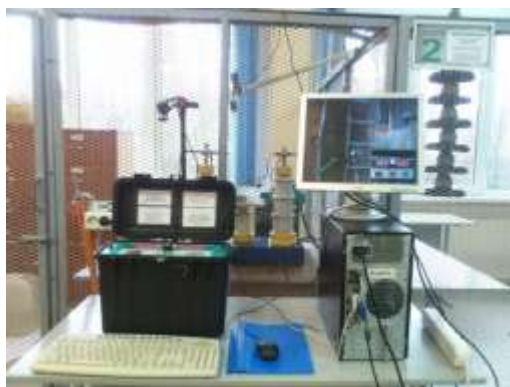
Рисунок 2 – Экспериментальная установка для моделирования электрической дуги в трансформаторном масле
