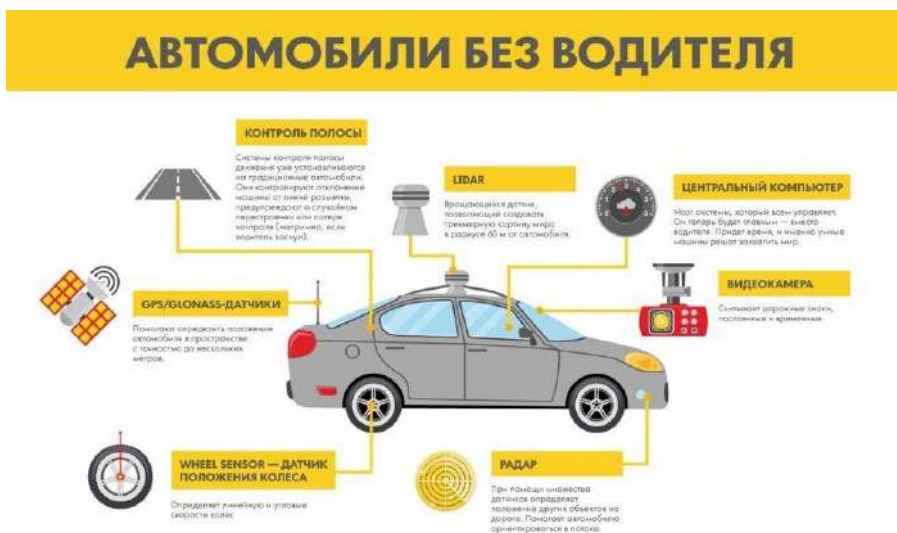
Устройства и датчики в беспилотном автомобиле
