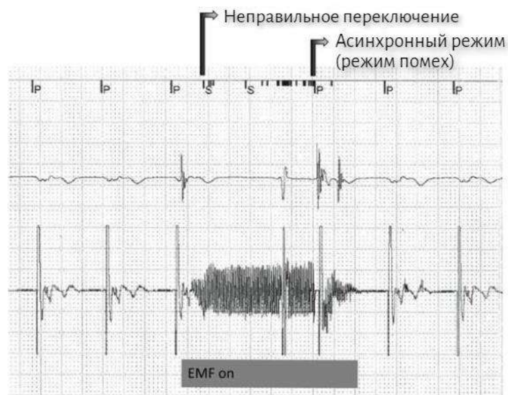
Электромагнитные помехи в кардиостимуляторе
