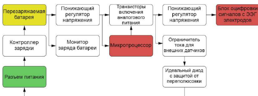
Функциональная схема блока питания миниатюрного многоканального электроэнцефалографа
