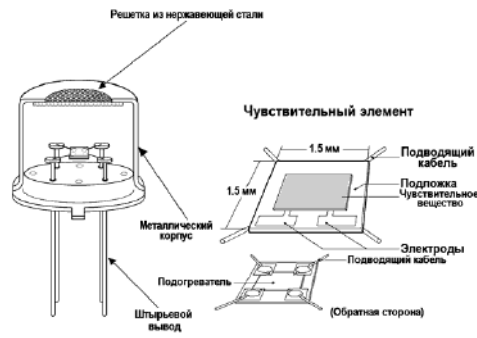
Рис.1. Состав датчика алкоголя
