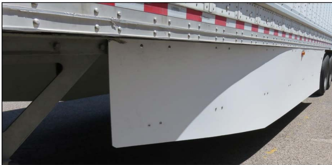
Рисунок 4. Пример тестирования аэродинамической юбки
