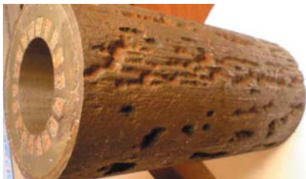
Рисунок 1. Язвенная коррозия корпуса ПЭД (с наличием канавок)
