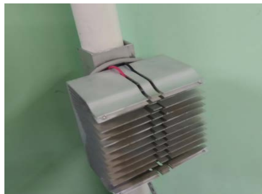
Рисунок 4. Подключение устройства к трубе горячего водоснабжения
