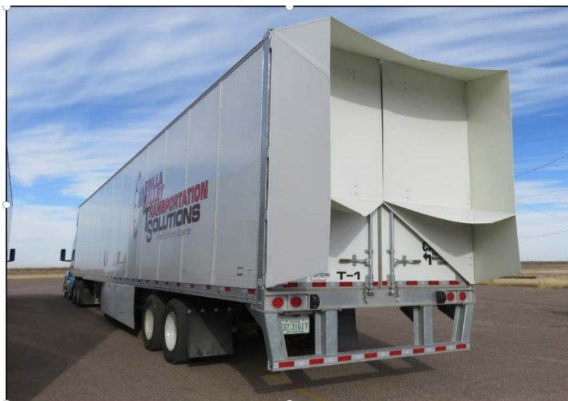
Рисунок 5. Испытательный прицеп (установлен «хвост» Aerovolution)
