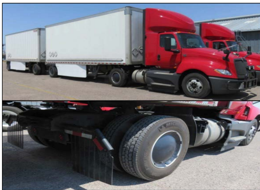
Рисунок 6. Пример тестирования аэродинамических колпаков на колёса
