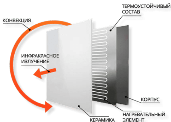
Рисунок 4. Устройство тепловой панели
