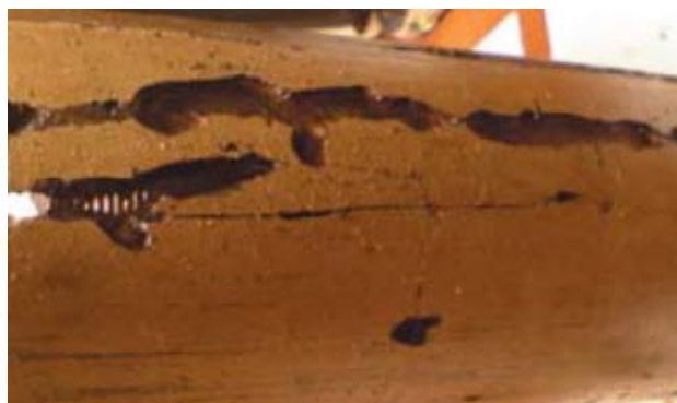
Рисунок 2. Мейза-коррозия корпуса ПЭД
