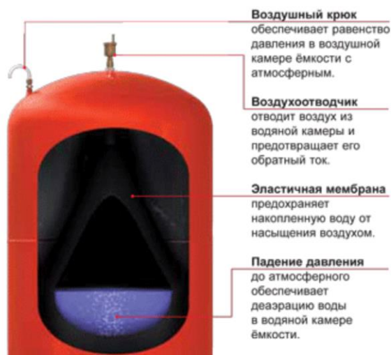
Рисунок 1. Устройство мембранного расширительного бака.
