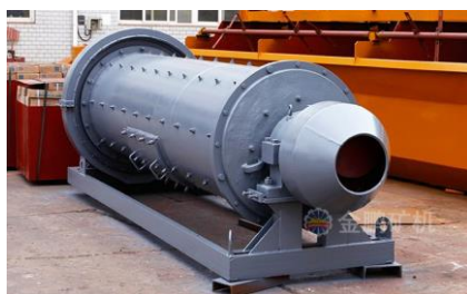
Рисунок 1. Корпус трубной шаровой мельницы мокрого помола.
