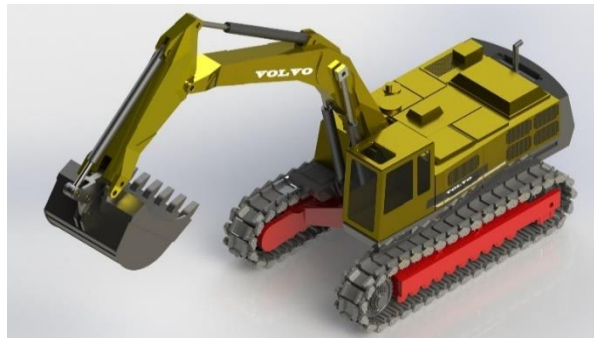
Рисунок 1. Компьютерная модель экскаватора EC650 спроектированного в среде SolidWorks
