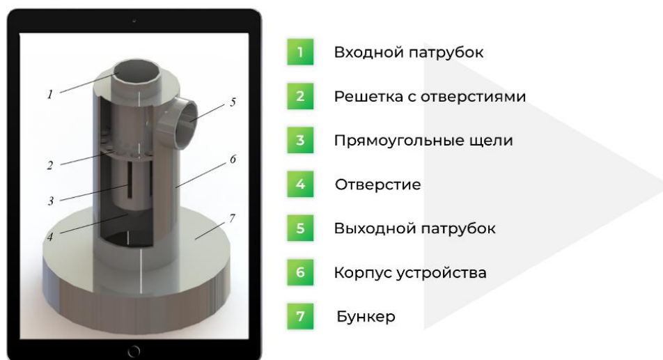
Информационная иллюстрация о строении мультивихревого классификатора
