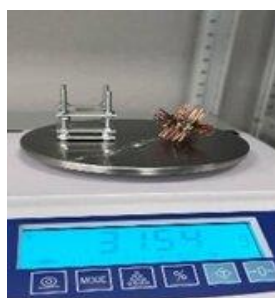
Рис. 11. Процесс замера массы готовой модели ПАС вместе с рамкой.
