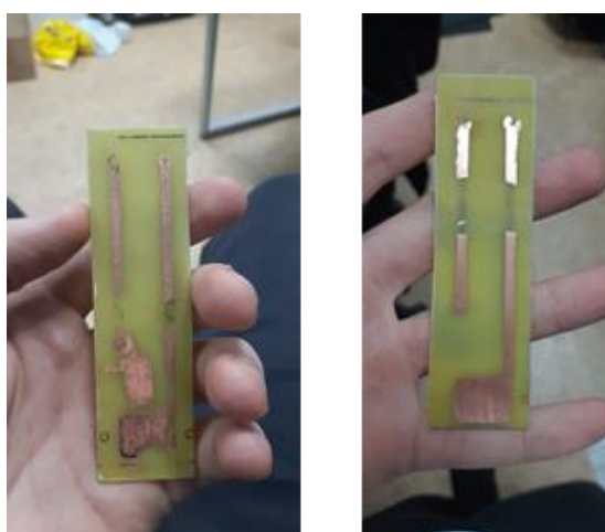
Рис. 1. Вытравленные экземпляры печатных плат
