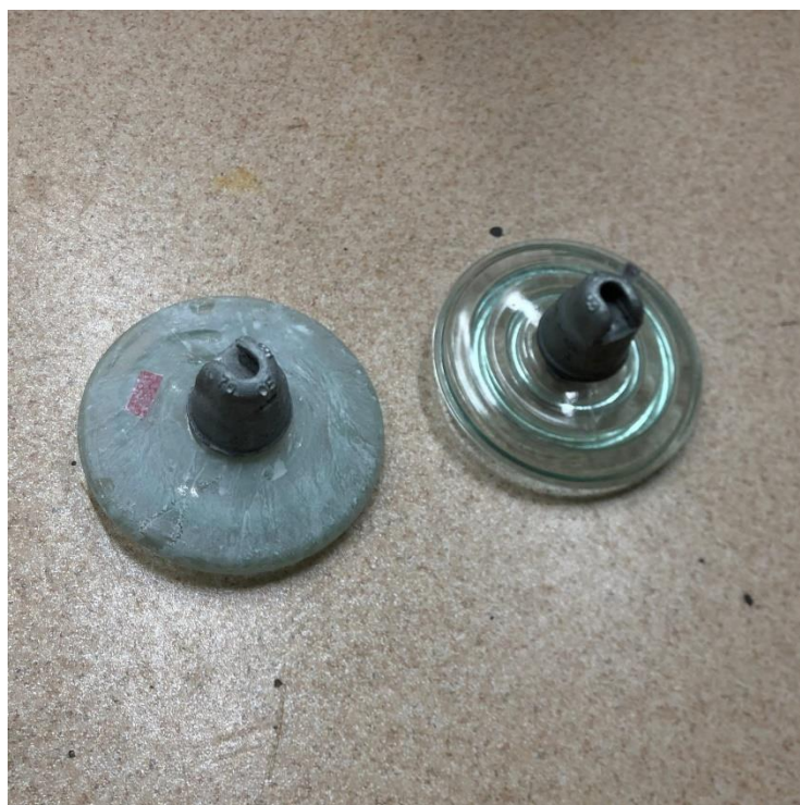
Рис. 1. Чистый и загрязненный изолятор ПС70Е, стеклянные
