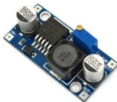
Рис. 2. Импульсный стабилизатор DC-DC LM2596 + схема
