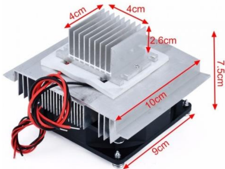
Рис.1. Соединение элемента Пельтье с радиаторами с двух сторон
