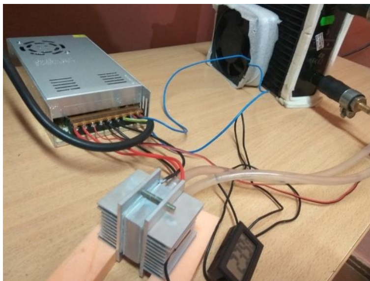
Рис.2. Испытание элемента Пельтье и расчёт температуры через радиаторы
