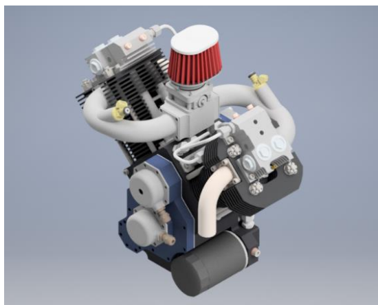
Рис.2. 3D – модель ДВС в среде AutodeskInventor
