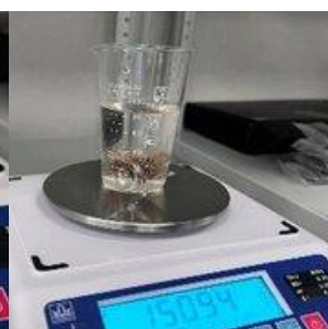
Рис. 14. Процесс замера веса и уровня воды в мензурке вместе с ПАС.
