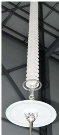
Рисунок 2 – Испытуемый изолятор из полимера четвертого поколения
