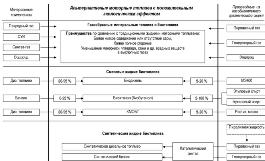
Рисунок 1 – Все виды альтернативных топлив, используемых в двигателях внутреннего сгорания
