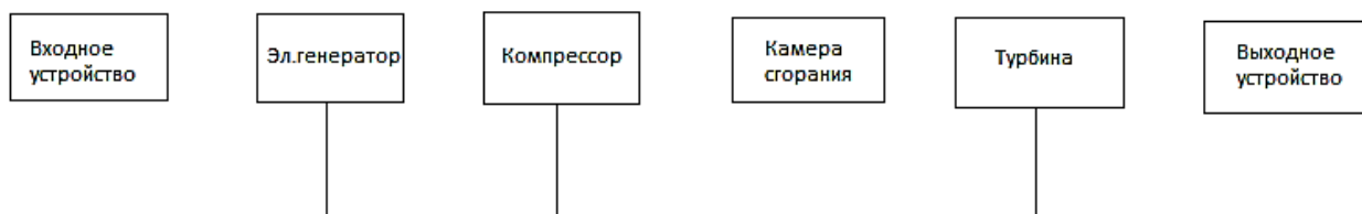
Расчётная схема одновальной ГТУ малой мощности SGT-300
