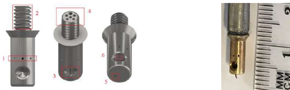
Рис. 2. Цилиндрический насадок с тремя отверстиями под углом 42 градуса (1), резьбовым наконечником (2), камерой торможения (3), пневмолиниями (4)
