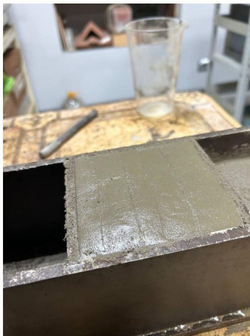
Рисунок 4 – Заполнение форм смесью
