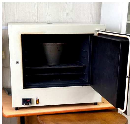
Рисунок 2 – Муфельная печь с тарой для обеззараживания органических отходов.
