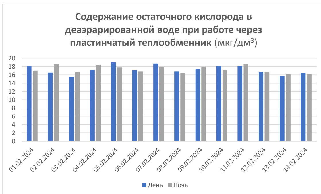
Рисунок 2 – Содержание кислорода в деаэрированной воде после реализации проекта
