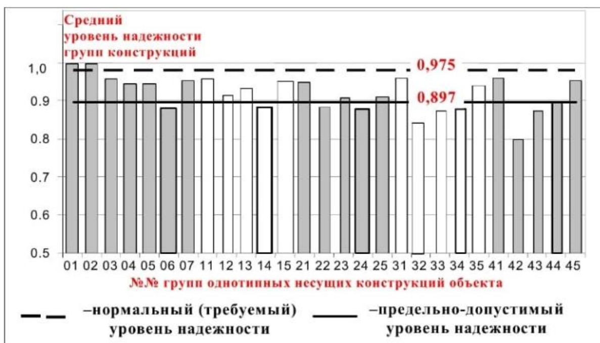
Рисунок 2 – Диаграмма средних уровней надёжности групп однотипных конструкций несущего каркаса здания поликлиники
