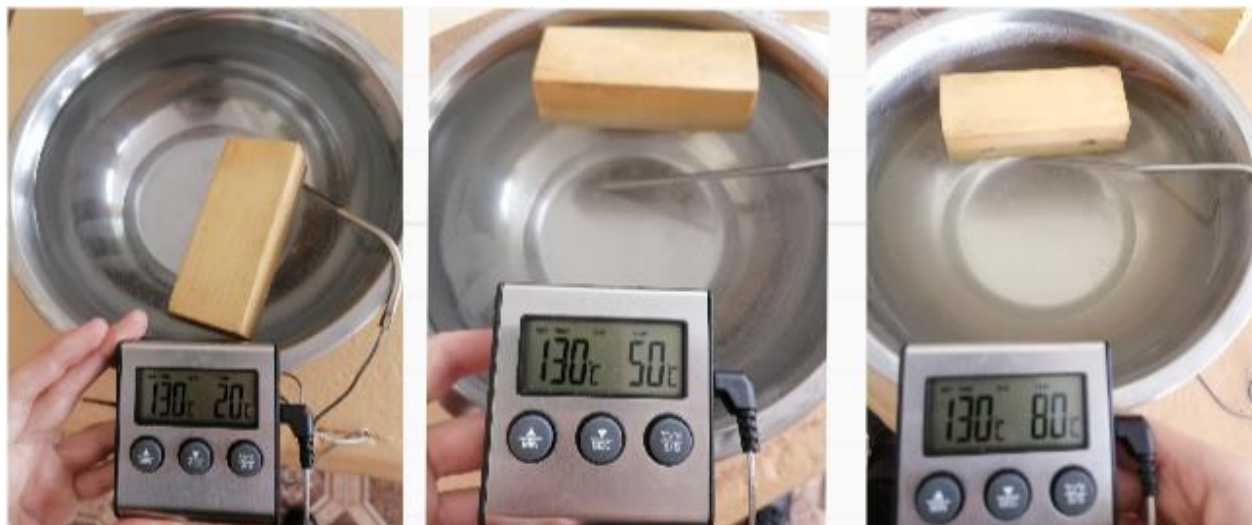
Рисунок 4 – Процесс погружения брусков в воду разной температуры
