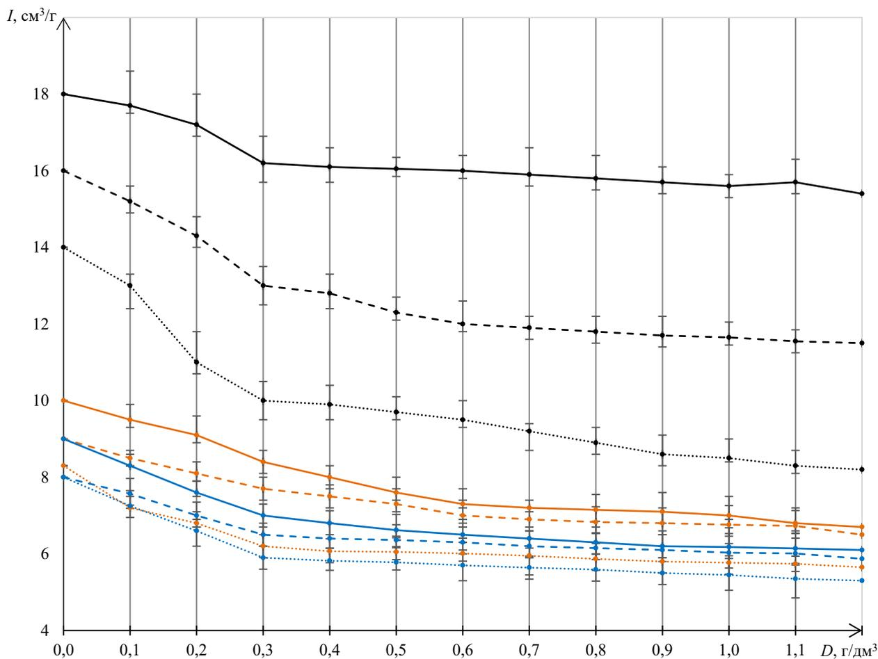
Рис. 1. Зависимость значения индекса центрифугирования (I) от вводимой дозы шлама (D): (черная) — 500 об/мин; (оранжевая) — 1 000 об/мин; (синяя) — 1 500 об/мин; — — — 1 мин; ..... — 2 мин; - · - · - 3 мин
