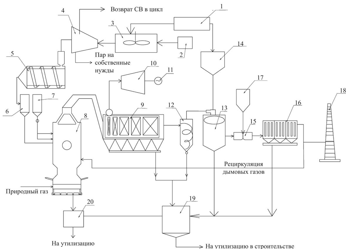
Рис. 2. Технологическая схема термической переработки осадков сточных вод:
