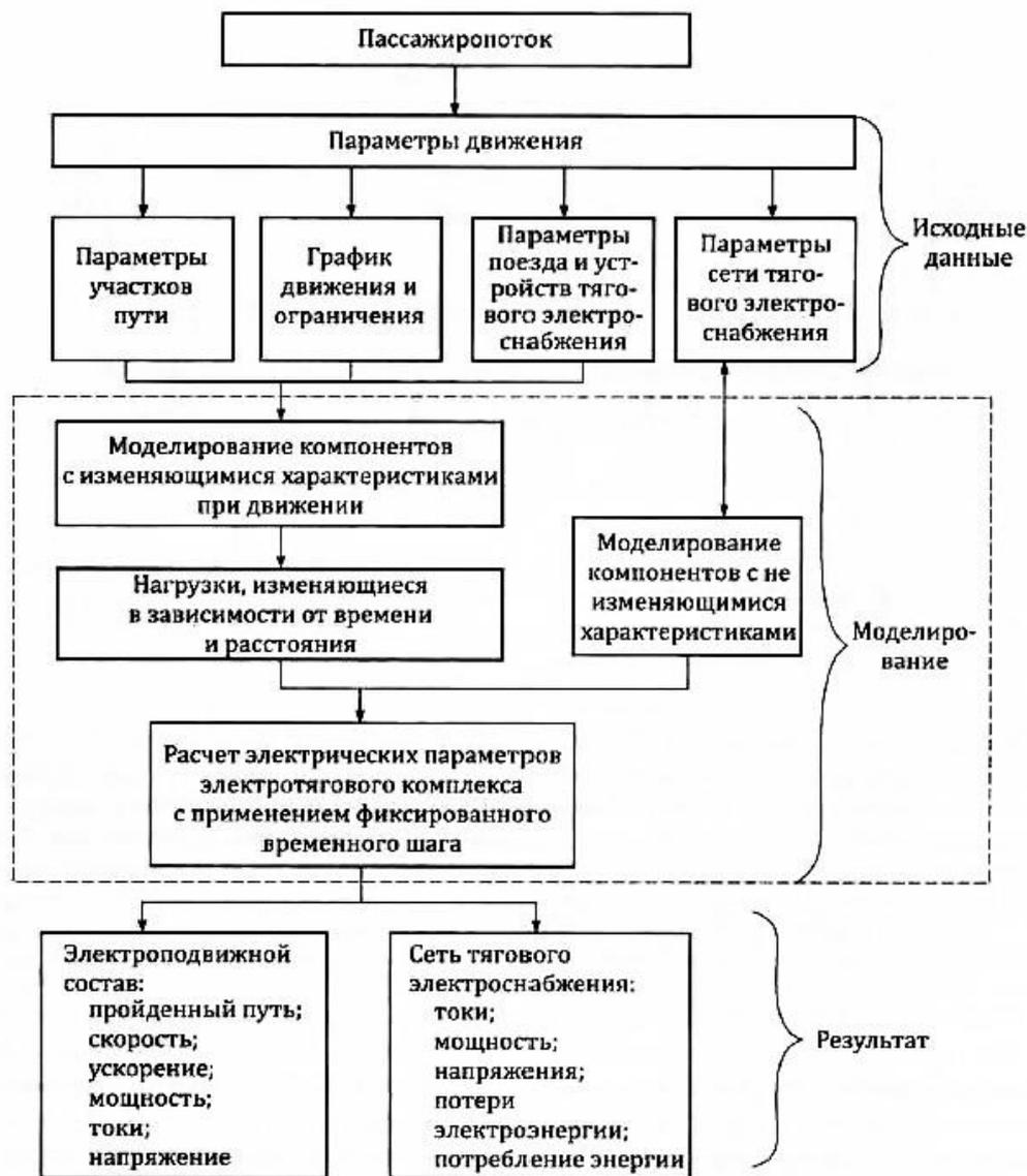
Рисунок 2. Алгоритм расчета электротягового комплекса методом математического моделирования
