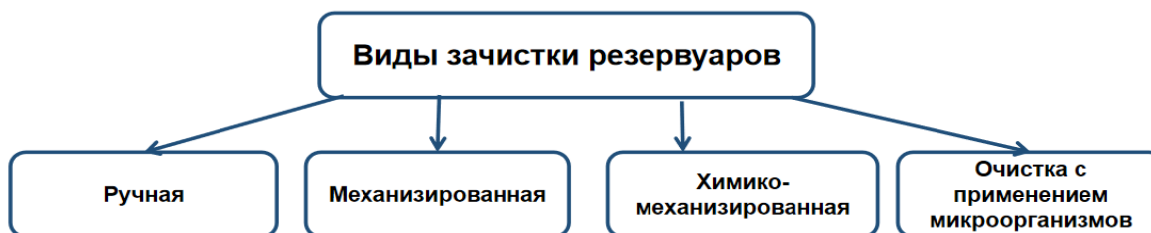
Рис. 4. Виды зачистки резервуаров
