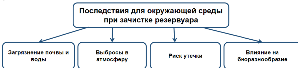
Рис. 3. Последствия для окружающей среды при зачистке резервуара
