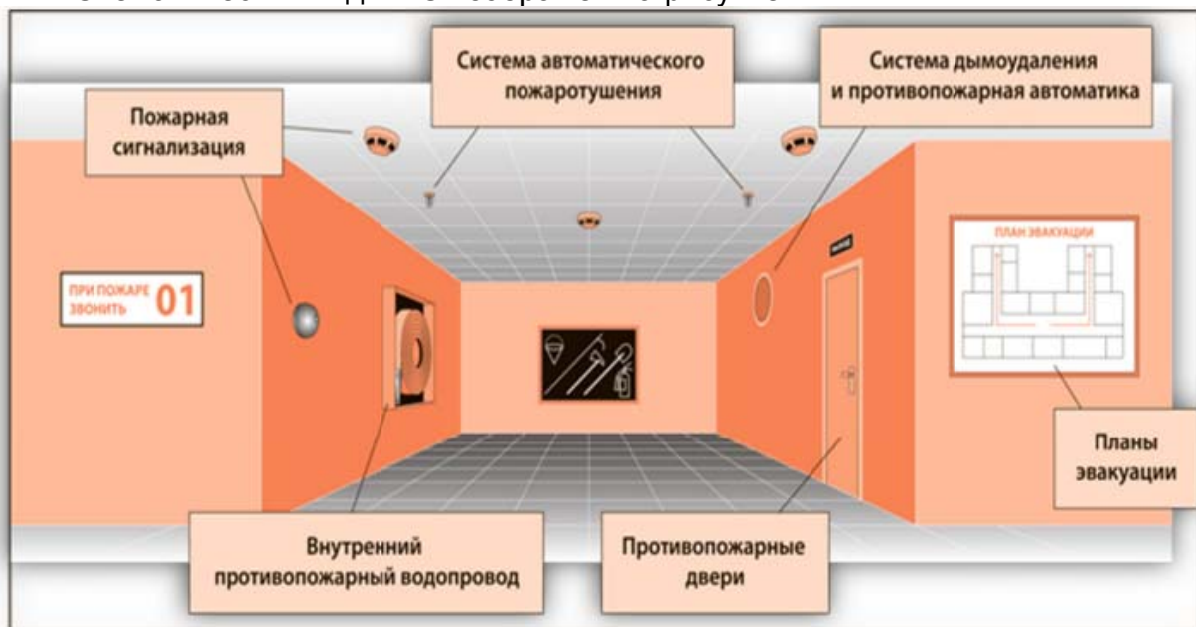
Рисунок 1. Устройство автоматической противопожарной системы
