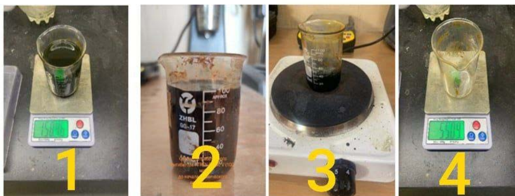
Рисунок 2. Исследование воздействия МЭА и h-iron на 90 минут термической коррозии на отобранные пробы забойной воды, насыщенной сероводородом до 80 ppm.
