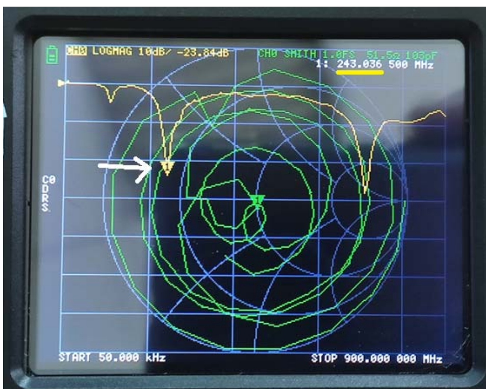
Рисунок 3. Резонансная частота для вибратора макета антенны длиной 28,8 см, стрелкой указано измеренное значение [Источник – личный архив авторов]
