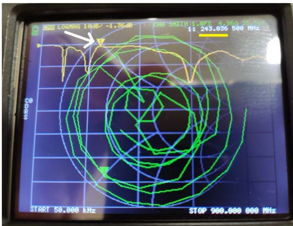
Рисунок 2. Резонансная частота антенны телескопического типа расчетной длины, стрелкой указано измеренное значение [Источник – личный архив авторов]
