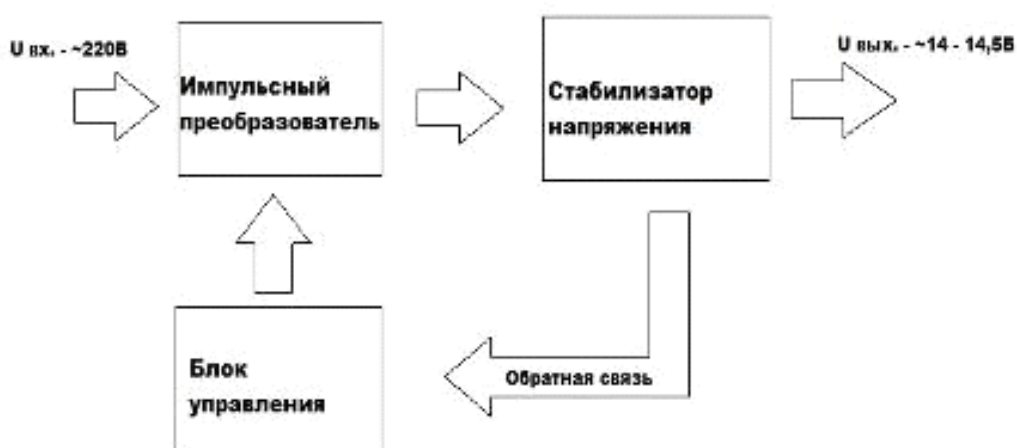
Функциональная схема автоматического зарядного устройства
