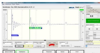
Рис.1. Форма сигнала при обрыве жил
