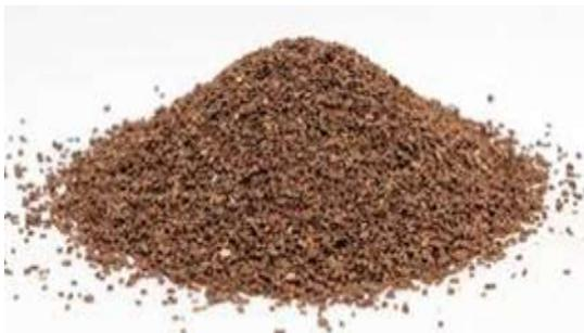
Рисунок 1. Гранулы фильтрующего материала ОДМ-5Ф (дунит) [2]
