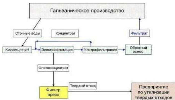
Рисунок 1. Станция очистки гальванических сточных вод
