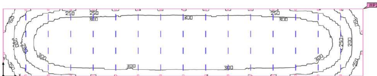
Рис.4 Освещенность в изолиниях для опалового рассеивателя
