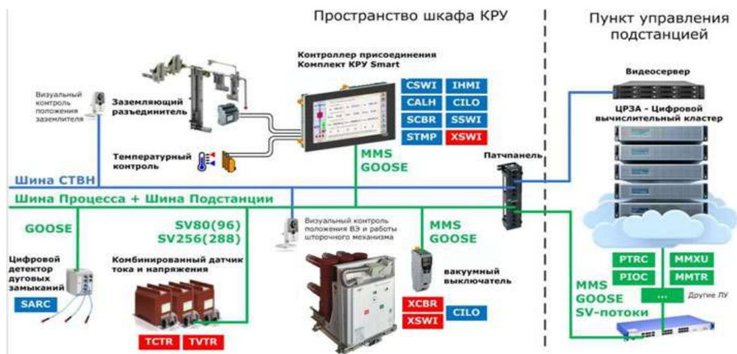
Рис. 1 Цифровой вычислительный кластер и основные ЛВС внутри цифрового шкафа КРУ
