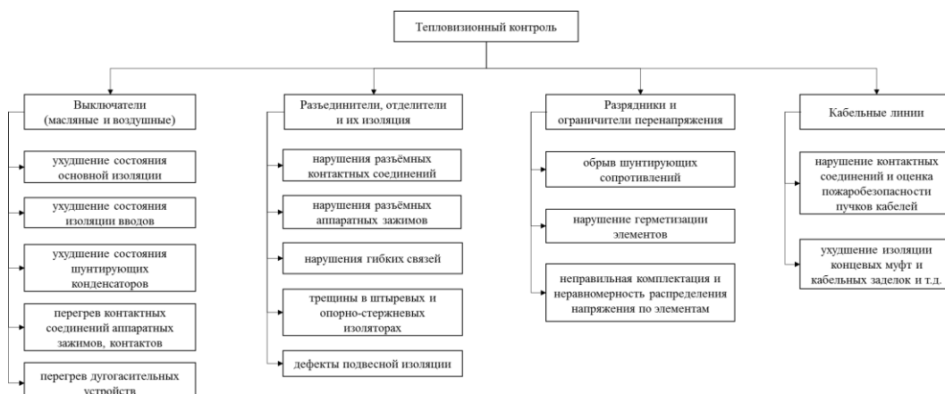
Рис. 1. Виды неисправностей в контактных системах аппаратов и кабелей Fig. 1. Types of faults in the contact systems of apparatus and cables
