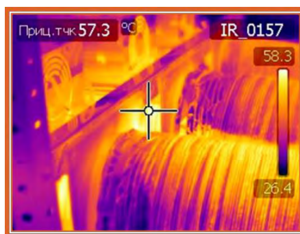
Рис. 4. Термограмма майнингового оборудования
