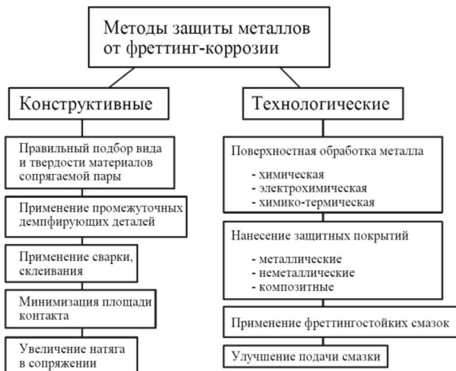
Классификация методов защиты от фреттинг-коррозии
