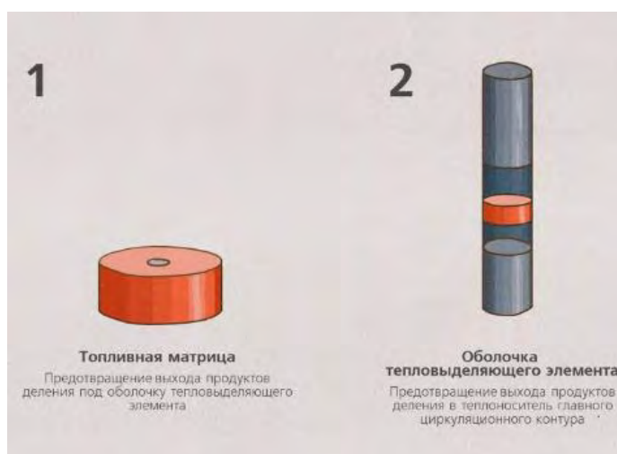
Рис.2 Барьеры безопасности на АЭС с ТВС
