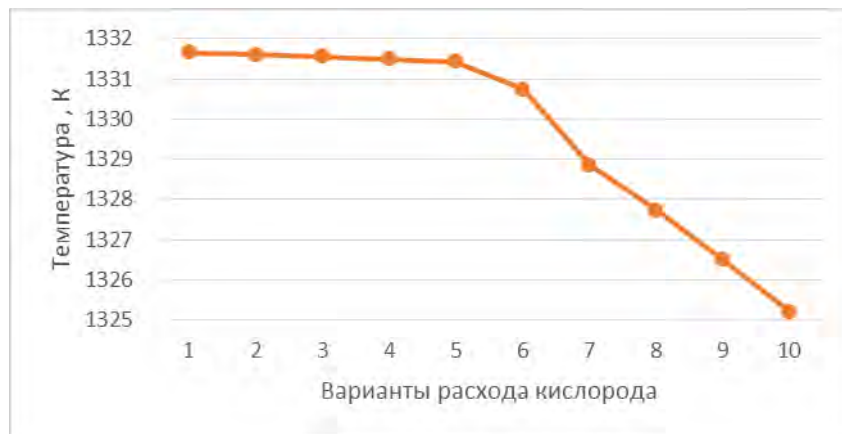
Рис. 2. Изменение температуры на выходе топливного элемента в зависимости от расхода кислорода
