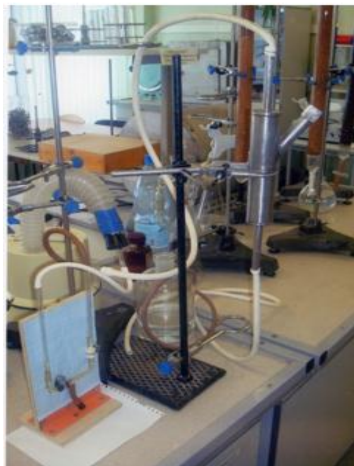
Рис. 1. Лабораторная установка очистки дымовых газов от диоксида серы суспензией карбонатного шлама
